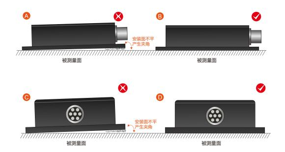
其次,传感器底边线和被测物体轴线不能有如E图所示的夹角产生,安装时应保持传感器底边线与被 测物体转动轴线平行或正交。本产品可水平安装也可垂直安装(垂直安装需要定制),正确安装方式如图 F所示。
