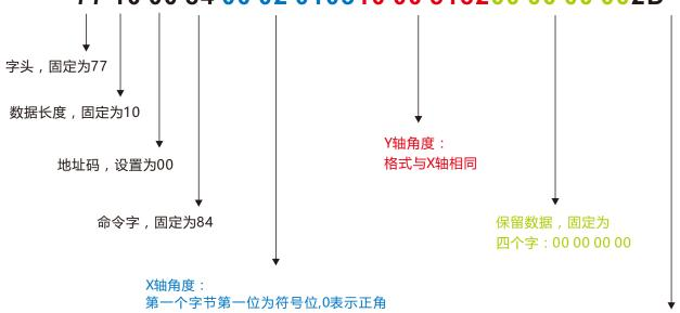
度, 1表示负角度 第一字节第二位和第二个字节为角度的 整数位,为压缩BCD码 第三个字节和第四字节为角度的小数 位,为压缩BCD码
