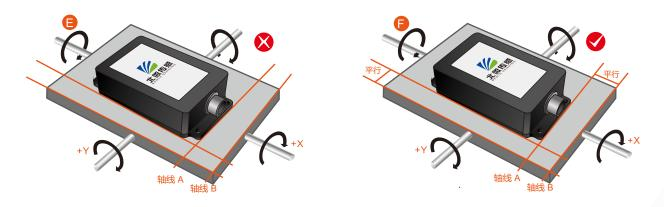
最后,传感器的安装面与被测量面必须固定紧密、接触平整、转动稳定,要避免由于加速度、震动产 生的测量误差。
