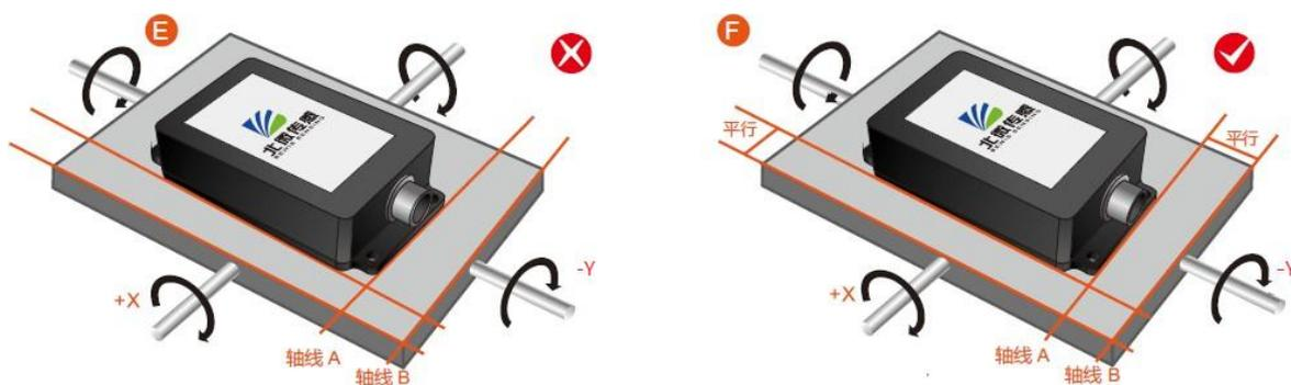
最后，传感器的安装面与被测量面必须固定紧密、接触平整、转动稳定，要避免由于加速度、振动产生的测量误差。
