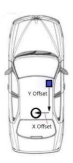
IMU 到天线相位中心的偏移量
