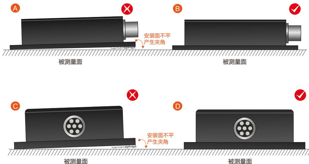
最后，惯性测量单元和机体紧密贴紧后，使用螺丝固定，保证固定紧密、接触平整、转动稳定，要避免由于加速度、振动产生的测量误差。切记此时螺丝只起固定作用，不起定位作用，惯性测量单元的螺孔被加工成椭圆形，便于调整。
