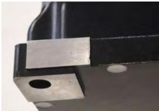
首先，要保证自身设备有两个绝对光滑的平面，并且两个面绝对垂直，尽可能与机体坐标系重合，以减小安装误差。
