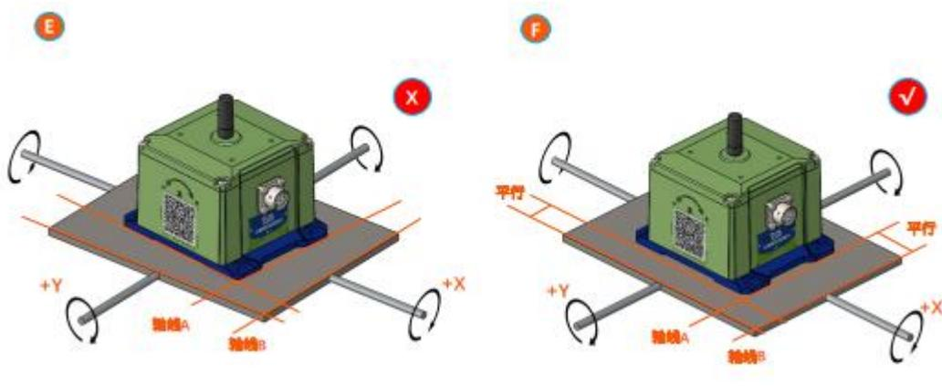
最后，传感器的安装面与被测量面必须固定紧密、接触平整、转动稳定，要避免由于加速度、振动产生的测量误差。
