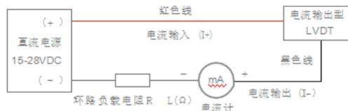
◆ 二线电流输出PLC接入型接线图:
