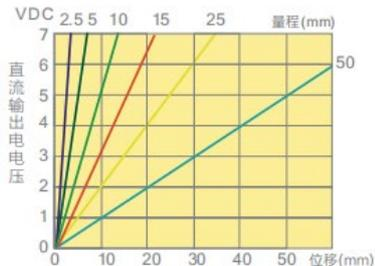
不同量程SDVB20Z系列0-10V输出电压和位移关系:
