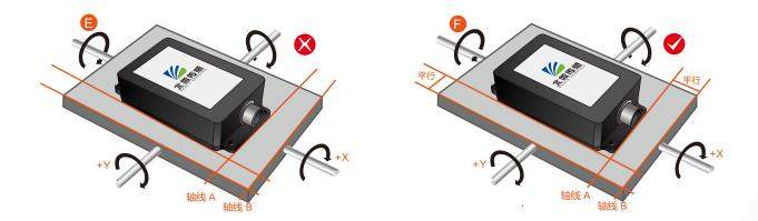
最后,传感器的安装面与被测量面必须固定紧密、接触平整、转动稳定,要避免由于加速度、震动产 生的测量误差。
