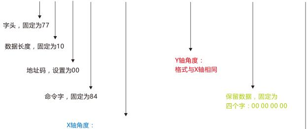
第一个字节第一位为符号位,0表示正角 度, 1表示负角度 第一字节第二位和第二个字节为角度的 整数位,为压缩BCD码 第三个字节和第四字节为角度的小数 位,为压缩BCD码
