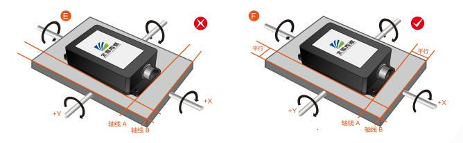
最后,传感器的安装面与被测量面必须固定紧密、接触平整、转动稳定,要避免由于加速度、振动产 生的测量误差。
