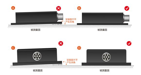
其次,传感器底边线和被测物体轴线不能有如E图所示的夹角产生,安装时应保持传感器底边线与被 测物体转动轴线平行或正交。本产品可水平安装也可垂直安装(垂直安装需要定制),正确安装方式如图 F所示。
